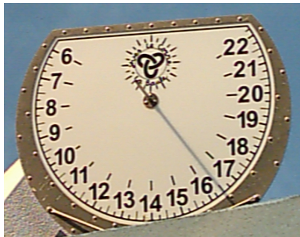
N° 2 : Un cadran à table parallèle à l'équateur, installé au sommet de ma maison à La Baule. Réalisé sur un matériau translucide, il est lisible sur sa face inférieure toute l'année, sauf aux équinoxes. Il indique l'heure légale ajustée manuellement de temps en temps*
