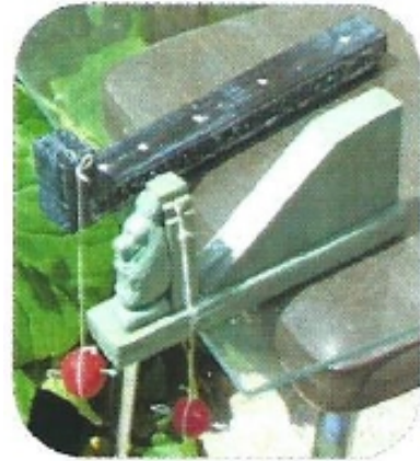
Sur deux maquettes, à l'échelle 1, projection de l'ombre sur les « points » horaires (midi solaire, le 24.05.15).
