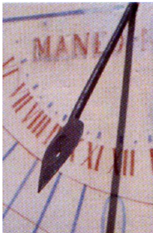
Une caractéristique des cadrans d'Albertis était le style en "pointe de lance avec trou".
