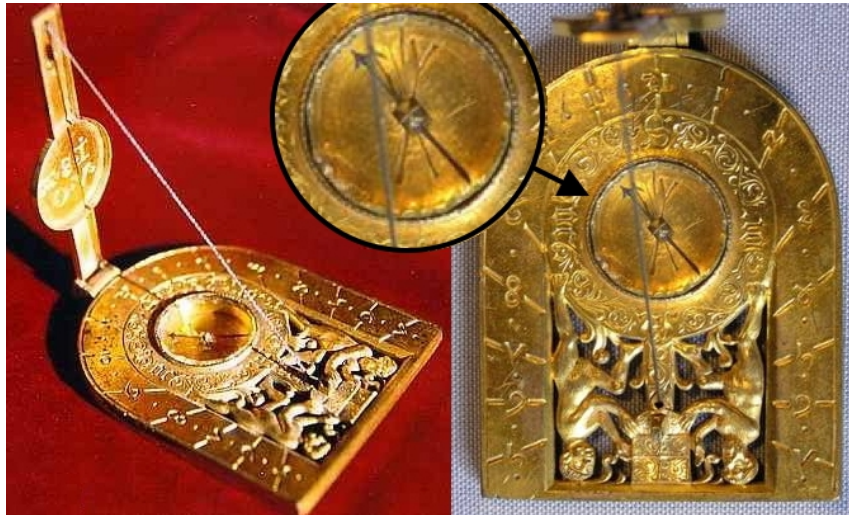
Fig. 2 : Le cadran construit en 1451 par Georg Peurbach pour l'Empereur Frédéric III. La photo de droite montre le fond de la boussole où apparaît une ligne oblique par rapport au Nord et qui marque la déclinaison magnétique.
